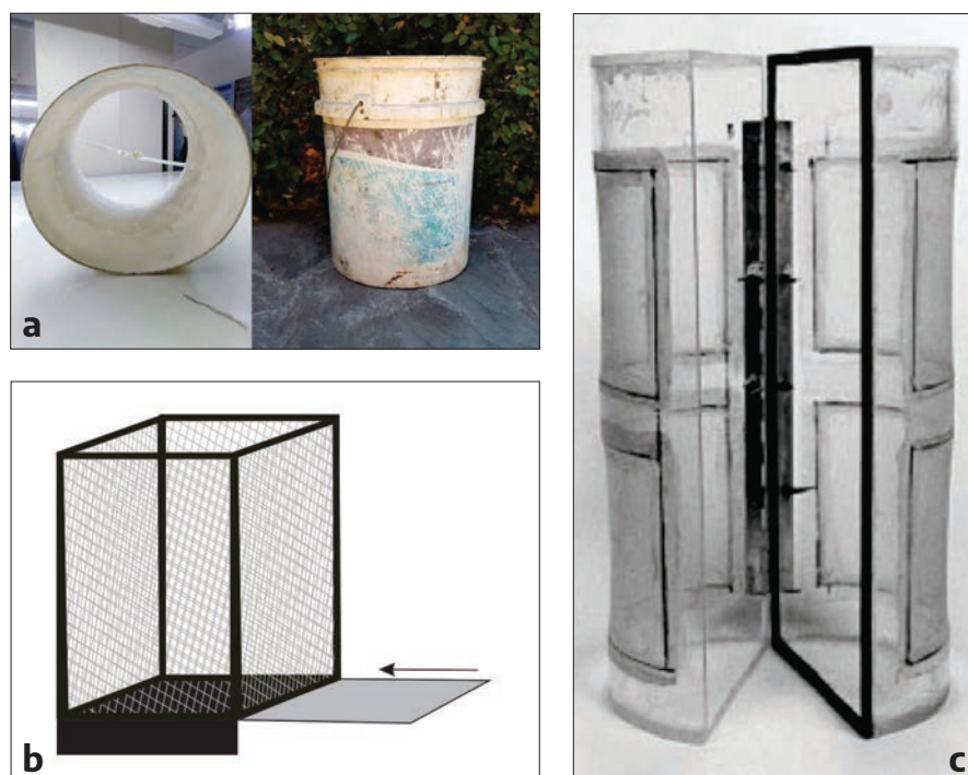
Fig. 2. Ejemplos de dispositivos para muestrear macroinvertebrados asociados a macrófitas sumergidas. a: dispositivo cilíndrico. b: Esquema muestreador de Gerking. c: Dispositivo diseñado por Kornijów (Extraído de Kornijów 1998).
