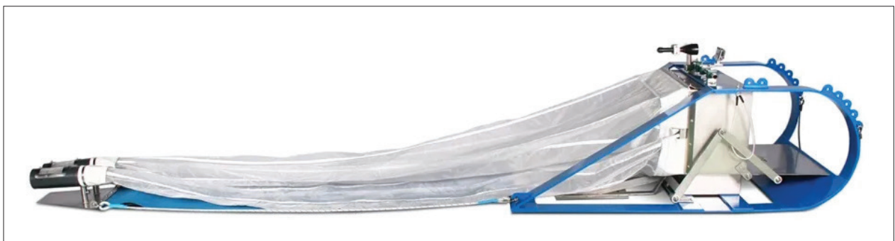
Fig. 9. Patín epibentónico de caja doble y dos redes de plancton que permite colectar dos muestras diferentes
