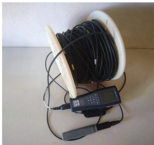
Fig. 1. Oxímetro óptico con fluorescencia y cable de 100 m para muestreo de lagos profundos que permite registros continuos de temperatura, concentración de oxígeno, % de saturación con calibración automática por presión atmosférica (altitud).
