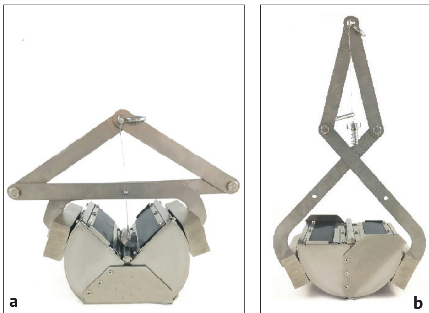
Fig. 4. Draga Ponar. En posición abierta durante el descenso (A), en posición cerrada, luego de coleccionar el material (B)
