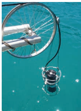
Fig. 2. Equipo de registro de luz. a: Disco de Secchi se utiliza de forma manual como medición de la transparencia. b: radiómetro sumergible de registro electrónico y continuo.
