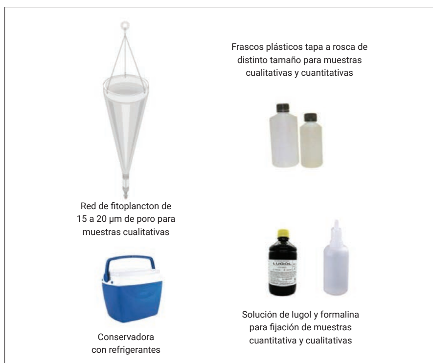
Fig. 1. Material necesario para tomar muestras cuali y cuantitativas de fitoplancton
