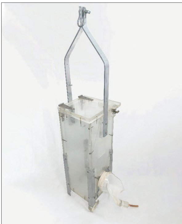
Fig. 4. Fotografía de una caja de Schindler de 12 L de capacidad. Nótese la red de plancton en la parte inferior derecha de la caja. Este modelo presenta una "compuerta" en la boca de la red para poder realizar muestras compuestas. La compuerta se abre manualmente cuando la caja se ha recogido de manera que se filtra por la red el volumen colectado, se vuelve a cerrar para poder realizar muestras compuestas sin perder lo colectado en la red.
