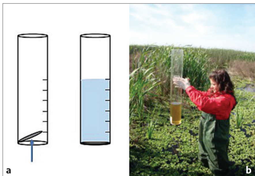
Fig. 1. a: Esquema del ingreso de agua en el tubo muestreador y del volumen de agua contenido luego de la recolección; b: tubo muestreador utilizado en una laguna vegetada del Parque Nacional Cielito de los Pantanos.
